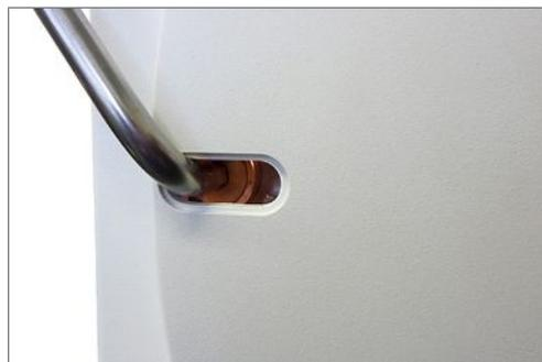
5. Drehen Sie den Innensechskantschlüssel zum Öffnen der Tür gegen den Uhrzeigersinn.
