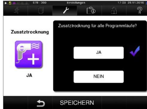
2. Wählen Sie durch Drücken der Schaltfläche JA oder NEIN, ob bei dem nächsten Programmlauf eine Zusatztrocknung erfolgen soll.
