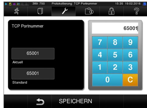
3. Löschen Sie den aktuellen TCP-Port mit der Taste C und geben Sie einen anderen TCP-Port ein.
