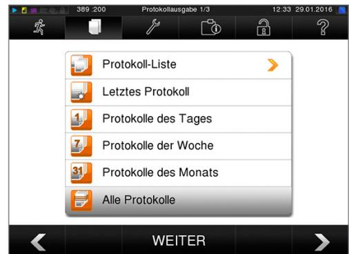
2. Es wird eine Liste mit allen Textprotokollen angezeigt, die im internen Speicher abgelegt sind. Um das Suchen zu erleichtern, können Sie die Sortierreihenfolge der Protokolle nach Datum, Programm bzw. Ergebnis durch Anwählen der Kopfzeile filtern.
