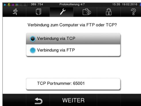
2. Drücken Sie auf diese Schaltfläche, um den voreingestellten TCP-Port zu ändern. Das Display wechselt in das Einstellungsfenster.
